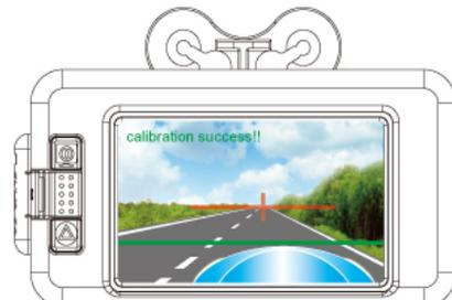
5. 此時按下遙控器上的 「強制錄影鍵」或本機「強制錄影鍵」出現「calibration .....」，表示正在校正中，請等待數秒鐘時間
