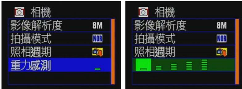
★注意：靈敏度越高代表重力(G)感測越靈敏，越容易觸發強制照相；每次觸發強制照相時，即會強制連拍 3 張影像。
