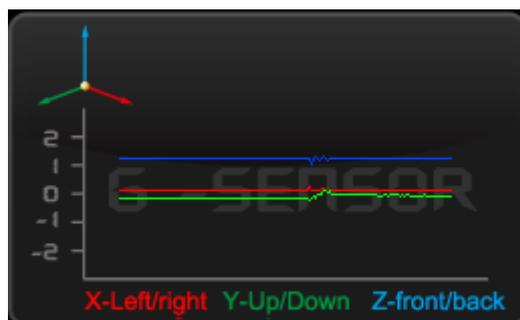
G-SENSOR：重力感測分析，當觸發G-Sensor強制錄影時，將顯示車輛的X、Y、Z軸變化的資料。
