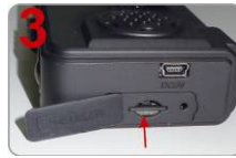
施力壓下 Micro SD 卡定 位
