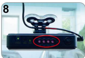
將線材落線定位好，電源接通時，IR 燈會先全亮
