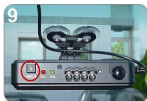
強制錄影鍵(FORCE)上之燈號微亮，常亮為正常供電
