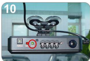
綠燈：閃爍為 GPS 3D 定位中 綠燈：常亮為 GPS 3D 已定位
